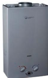
Газовый проточный водонагреватель WERT RUS 10LT работает на природном газе и предназначен для нагрева холодной проточной воды. Прибор оснащен системой принудительного дымоудаления, что позволяет устанавливать его в местах с недостаточной естественной тягой. Нагреватель обладает целым рядом устройств безопасности, таких как: датчик контроля тяги, пламени, защиты от перегрева, сетчатый фильтр и т. п. В комплекте с прибором так же идет дымоход.
