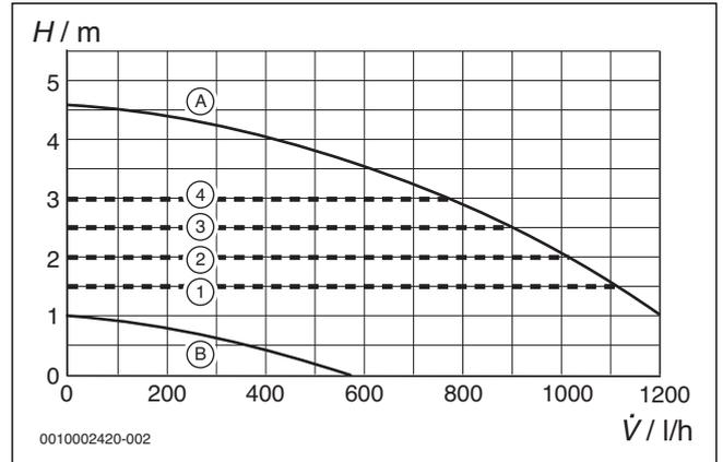
Рис. 81 Поля характеристик и характеристики насоса
