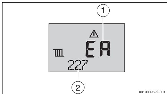
Рис. 78 Пример: индикация запирающей неисправности
