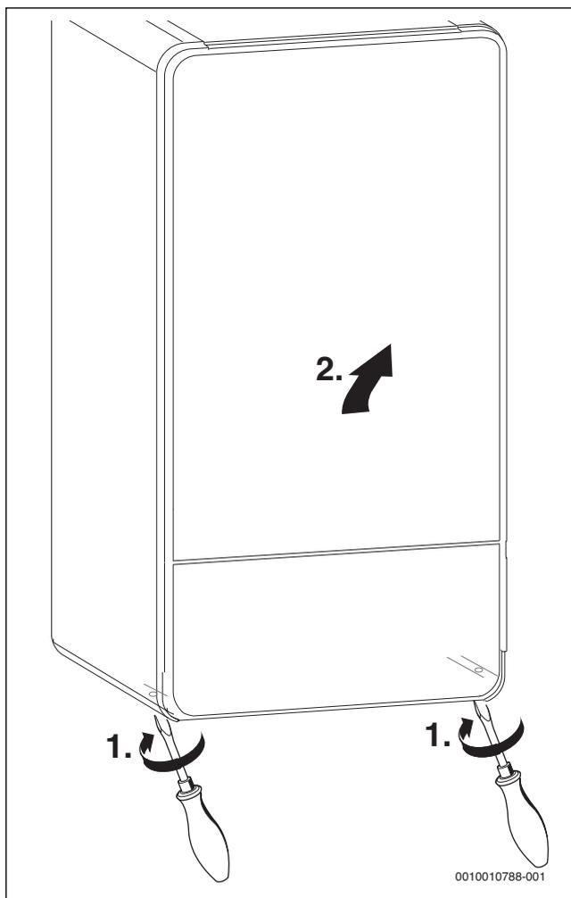
Рис. 22 Снятие облицовки
