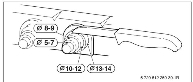
Рис. 30 Обрежьте фиксатор в соответствии с диаметром провода
