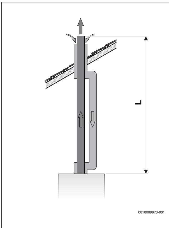
Рис. 15 Вертикальный отвод дымовых газов по С<sub>33</sub>
