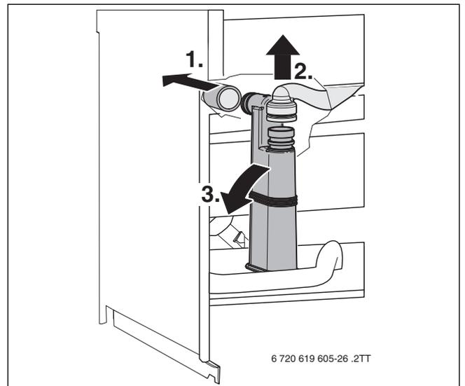
Рис. 59 Демонтаж конденсатного сифона
