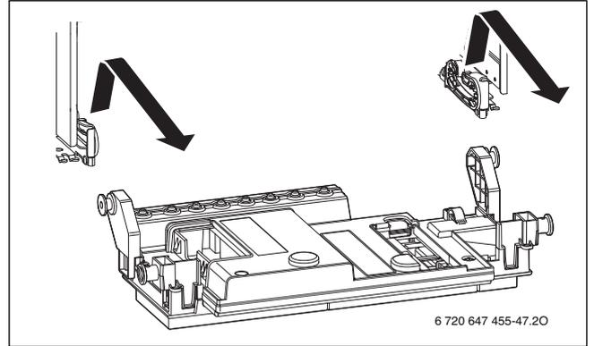
Рис. 73 Снимите блок управления
