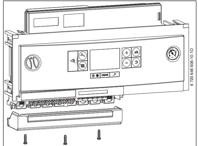
Рис. 29 Снимите крышку
