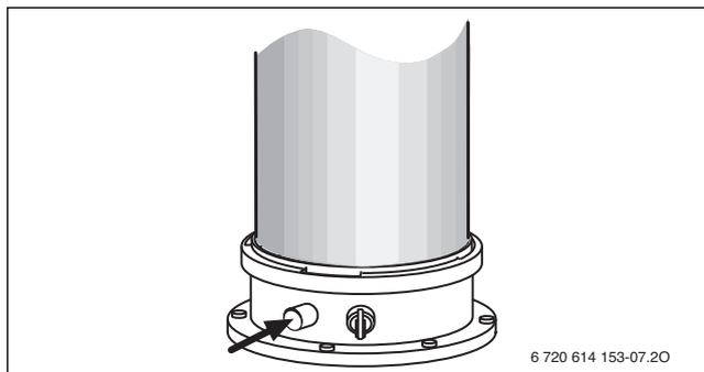
Рис. 44 Штуцер для измерения дымовых газов
