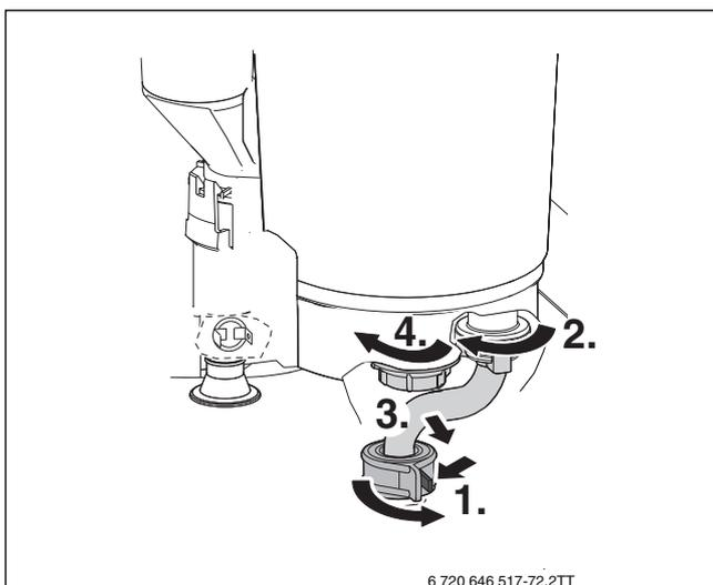
Рис. 75 Отверните гайку и отсоедините трубу обратной линии
