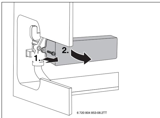
Рис. 61 Демонтаж пластинчатого теплообменника
