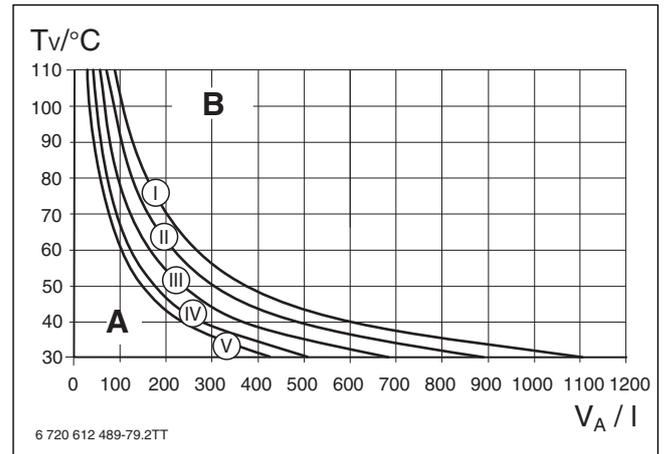
Рис. 21 Характеристики расширительного бака
