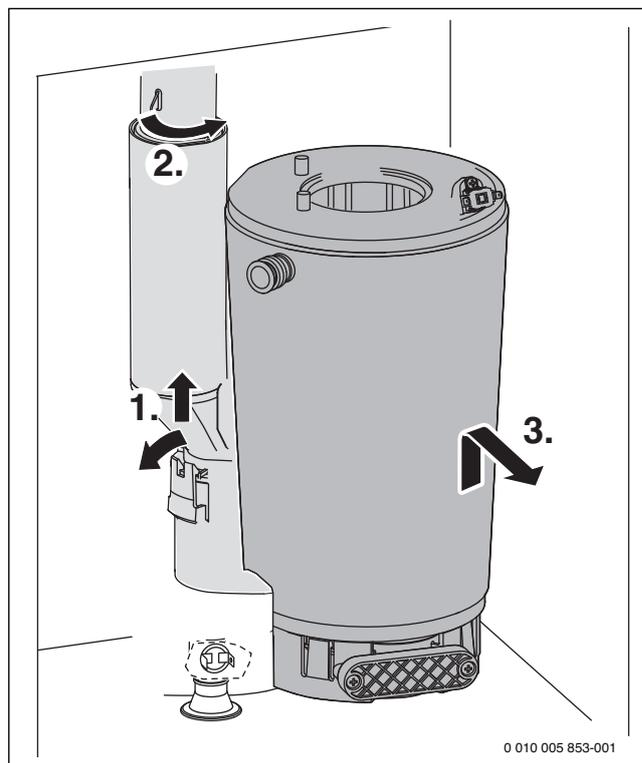
Рис. 76 Демонтаж теплообменника
