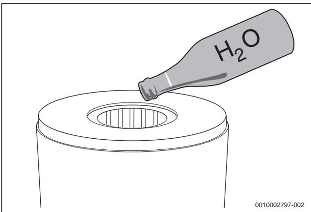
Рис. 58 Промывка теплообменника водой
