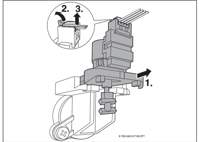
Рис. 65 Демонтаж сервопривода 3-ходового клапана
