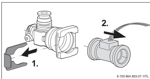
Рис. 63 Демонтаж турбины на трубе холодной воды
