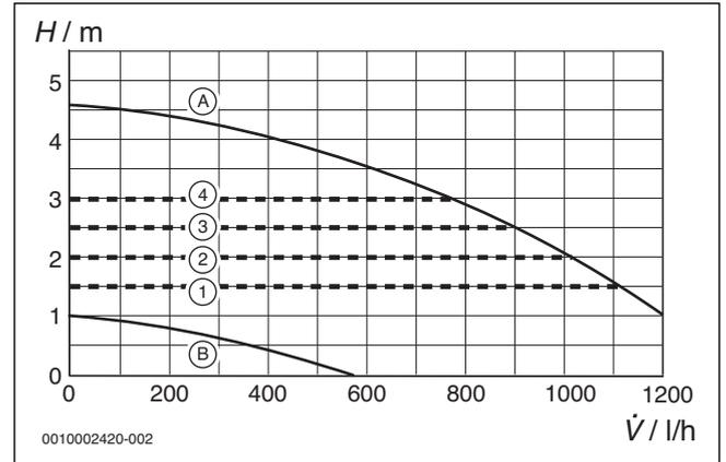
Рис. 81 Поля характеристик и характеристики насоса
