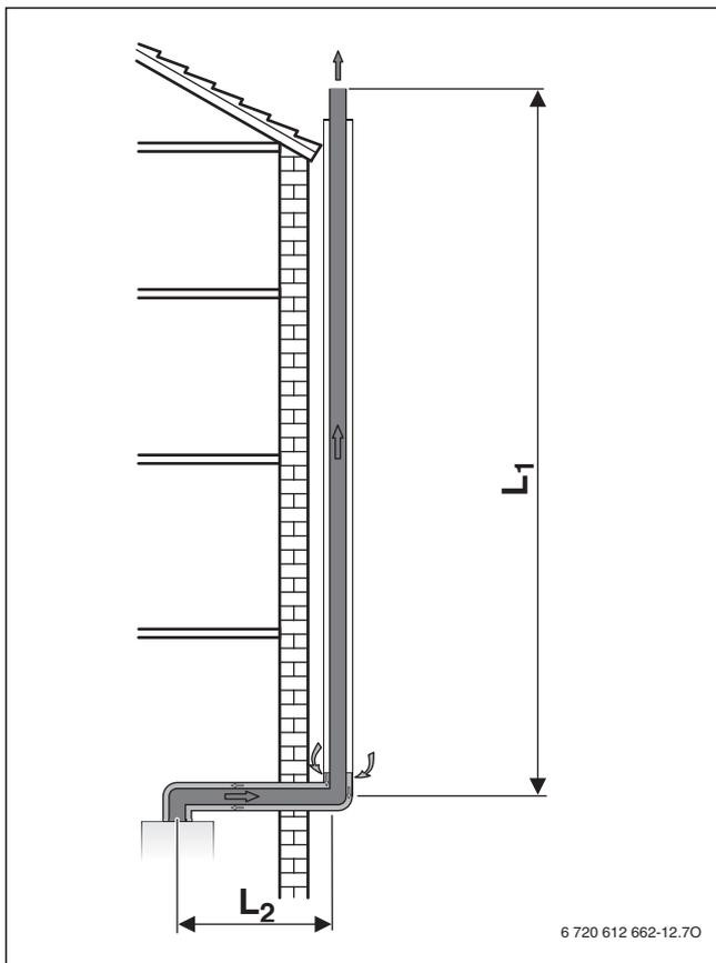
Рис. 16 Дымовая труба на фасаде по С<sub>53</sub>
