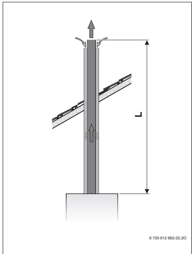
Рис. 14 Вертикальный отвод дымовых газов по C<sub>33</sub>
