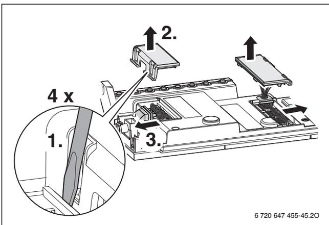
Рис. 72 Снятие крышки
