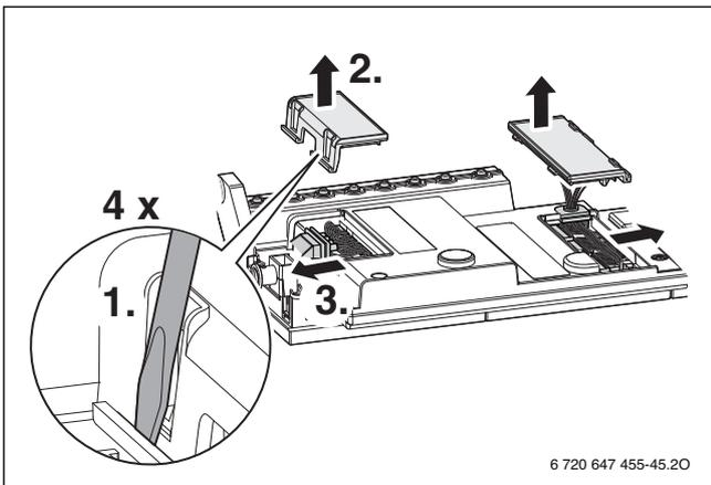
Рис. 72 Снятие крышки
