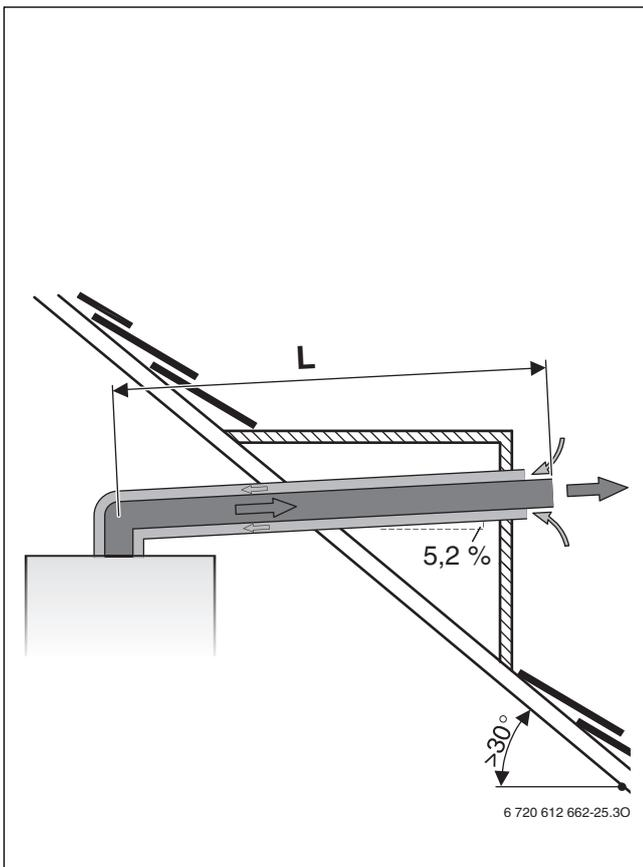
Рис. 12 Горизонтальный отвод дымовых газов по C<sub>13</sub>
