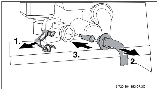
Рис. 62 Выньте сетчатый фильтр из трубы холодной воды
