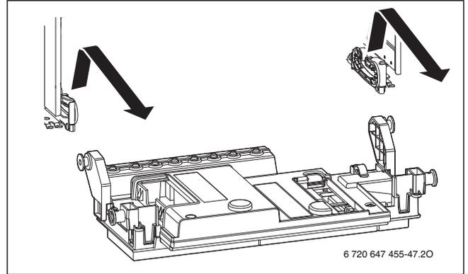
Рис. 73 Снимите блок управления
