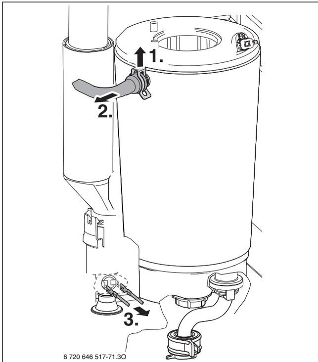
Рис. 74 Отсоедините трубу подающей линии и провода
