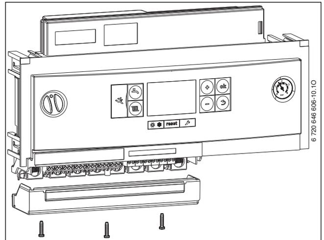
Рис. 29 Снимите крышку
