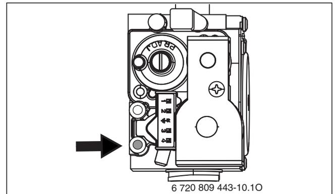
Рис. 47 Штуцер для выполнения замеров давления газа
