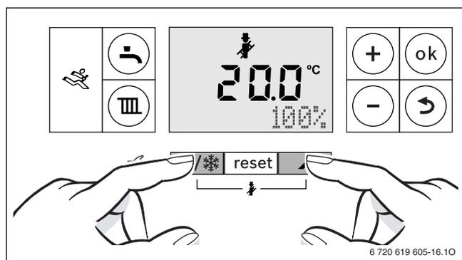
Рис. 48 100 % (максимальная номинальная теплопроизводительность ГВС)
