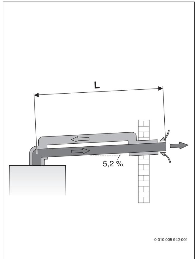
Рис. 13 Горизонтальный отвод дымовых газов по C<sub>13</sub>
