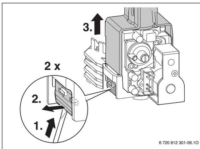
Рис. 69 Демонтаж газовой арматуры
