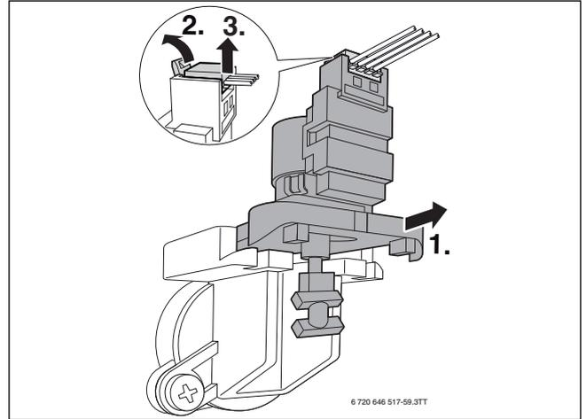
Рис. 65 Демонтаж сервопривода 3-ходового клапана
