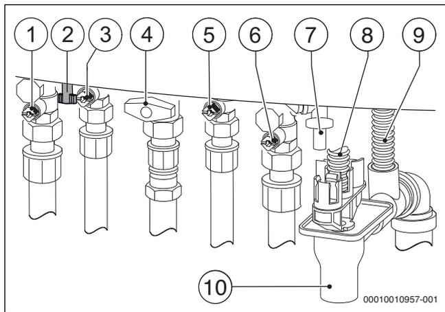
Рис. 27 Подключения газа и воды (дополнительная комплектация)
