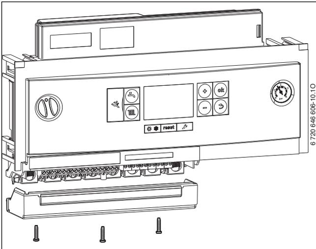
Рис. 70 Снятие крышки
