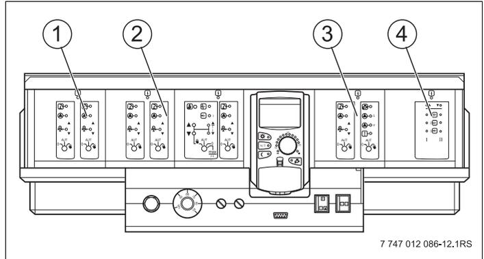
Рис. 9 Расположение разъемов 1 – 4 (здесь: Logamatic 43xx)
