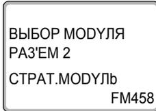
Функциональный модуль FM458 ("СТРАТ.МОДУЛЬ") установлен в разъем 2.
