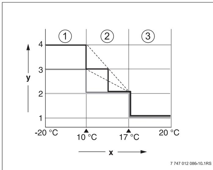
Рис. 7 Диаграмма ограничения нагрузки по наружной температуре
