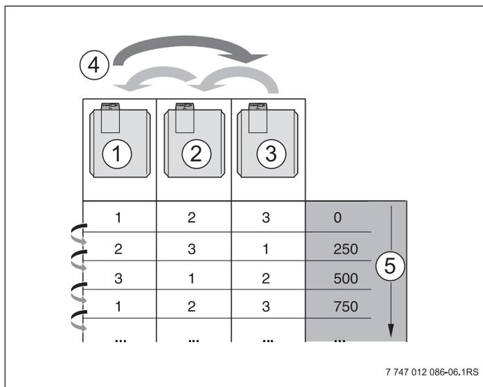
Рис. 6 Переключение последовательности котлов по отработанным часам
