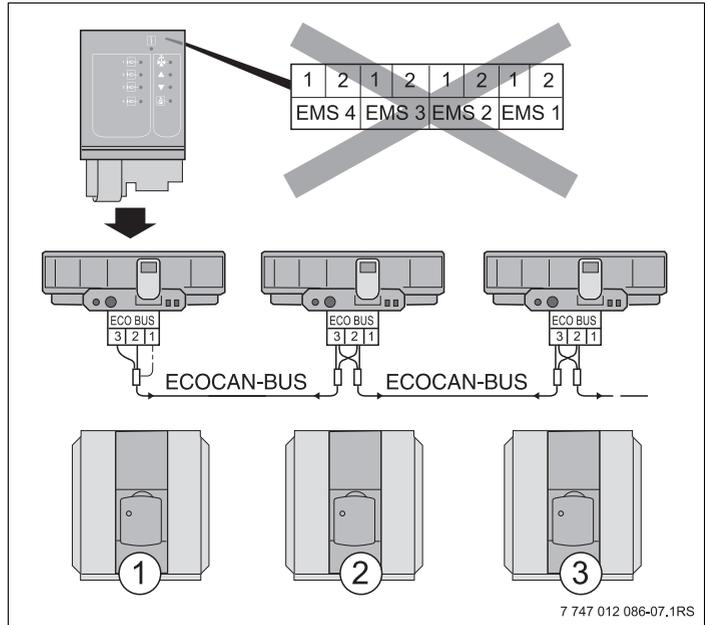
Рис. 11 Система из нескольких котлов с Logamatic 4000
