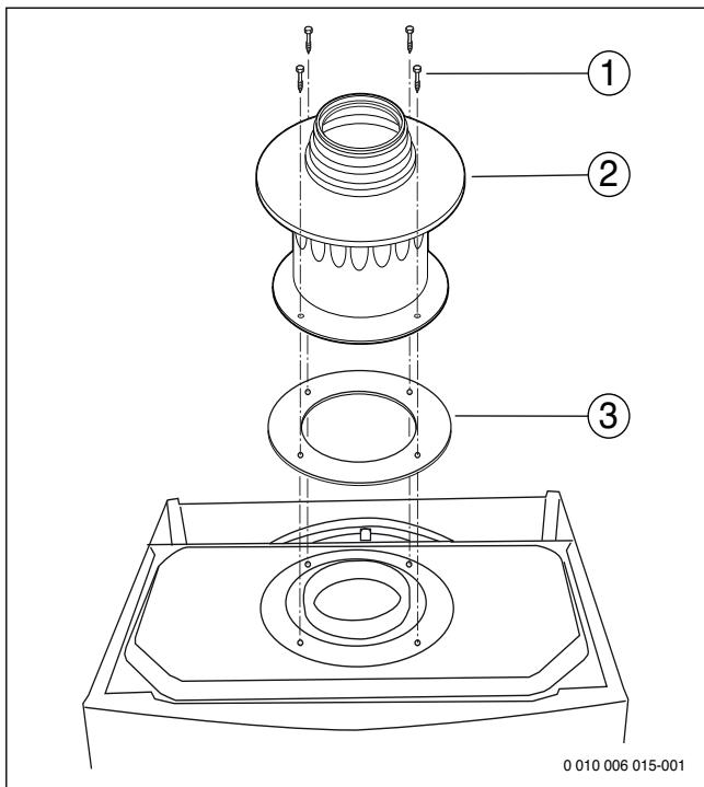
**Рис. 17** При вертикальном отводе дымовых газов  $B_{22}$  и мощности котла = 35 кВт: установите адаптер и дроссельную диафрагму
