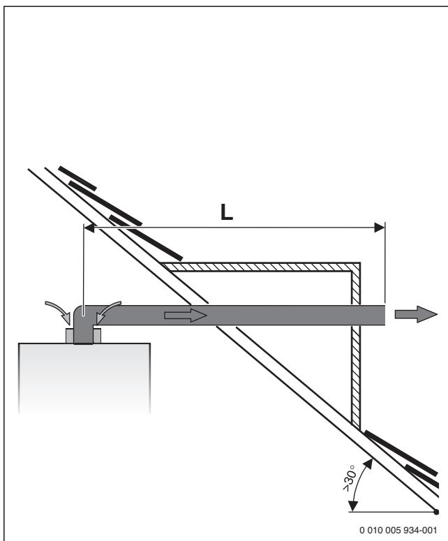
Рис. 4 Горизонтальный отвод дымовых газов B<sub>22</sub>
