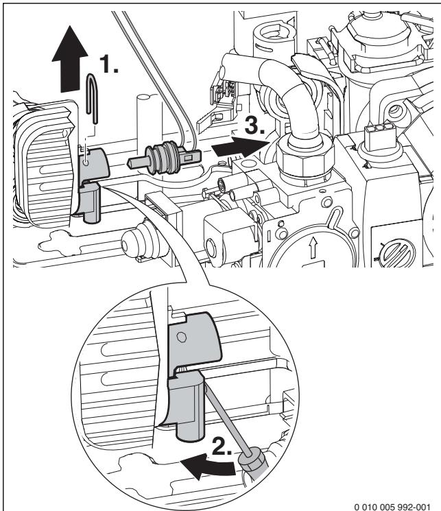
Рис. 38 Демонтаж датчика температуры горячей воды
