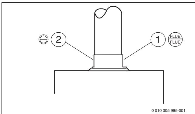
Рис. 31 Штуцер для измерения дымовых газов и штуцер для измерения воздуха для горения
