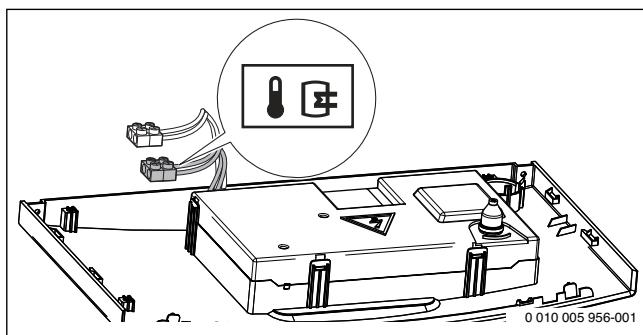
Рис. 22 Подключение датчика температуры бака-водонагревателя
