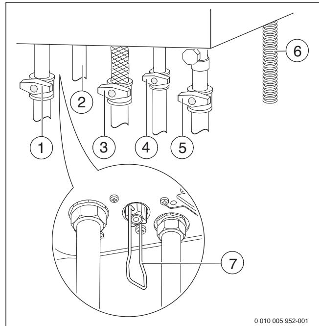
**Рис. 18** Подключения газа и воды (дополнительная комплектация)
