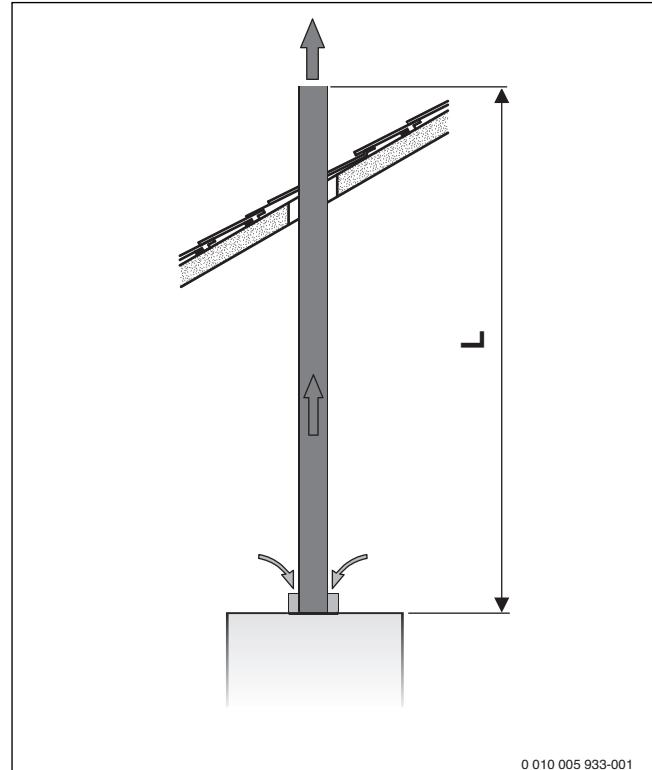
Рис. 5 Вертикальный отвод дымовых газов B<sub>22</sub>
