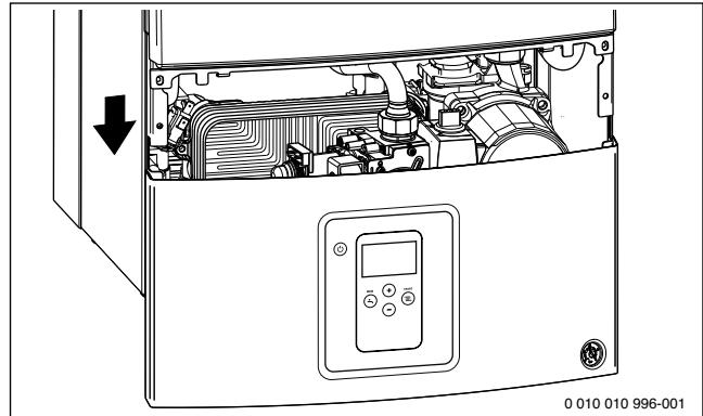
Рис. 29 Подвешенный на раме блок управления для одновременной работы с газовой арматурой
