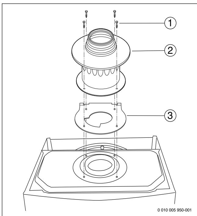
Рис. 16 При отводе дымовых газов  $B_{22}$  и мощности котла < 35 кВт: установите адаптер и дроссельную диафрагму
