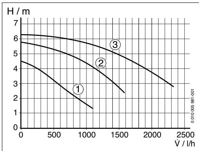
Рис. 28 Характеристики насоса отопительного контура (мощность котла = 35 кВт)
