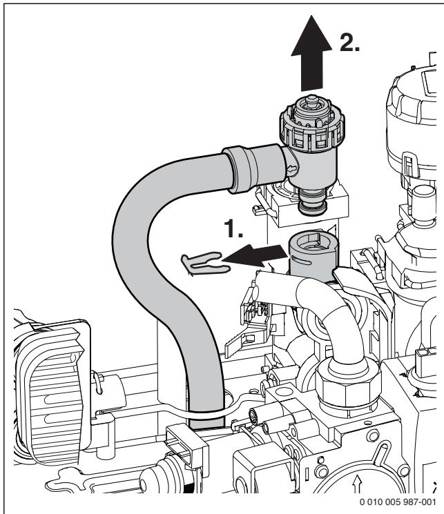
Рис. 33 Демонтаж предохранительного клапана (отопительного контура)
