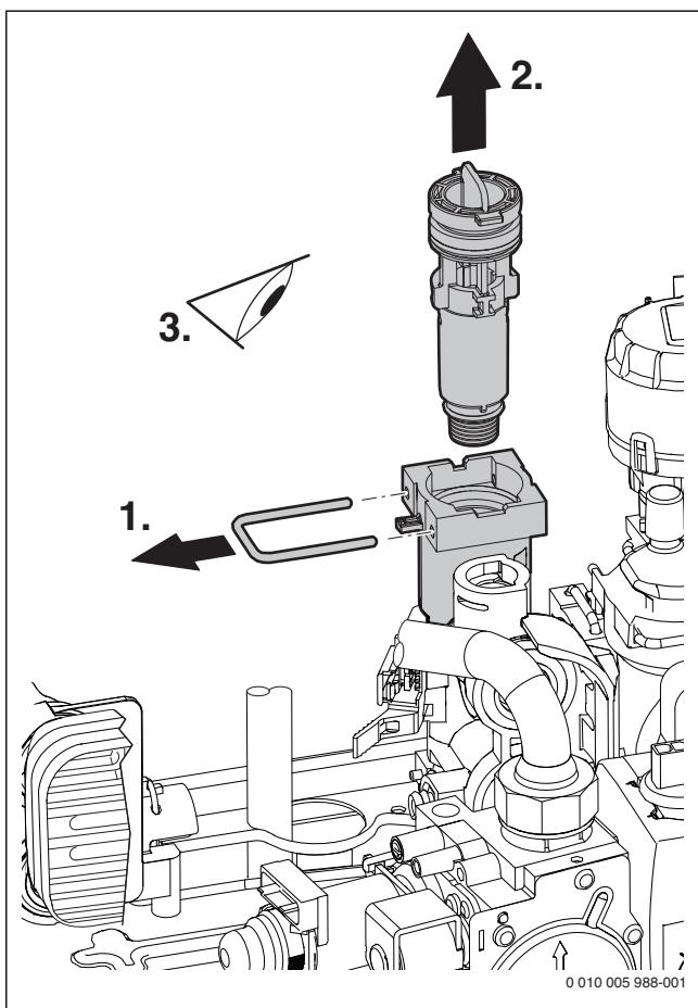
Рис. 34 Проверка фильтра в трубе холодной воды
