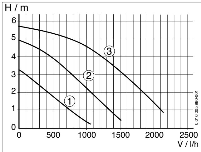
Рис. 27 Характеристики насоса отопительного контура (мощность котла < 35 кВт)
